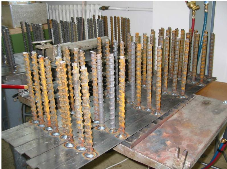
*Bild 4:* Durchstanzleisten mit HFV-Ankern
