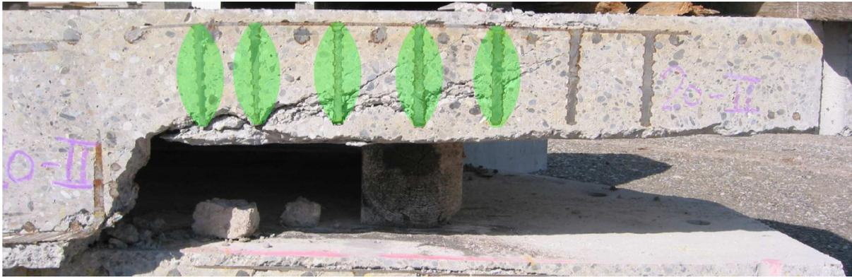
**Bild 12:** Versuchskörper mit modellhaft dargestellten Verbundankern
