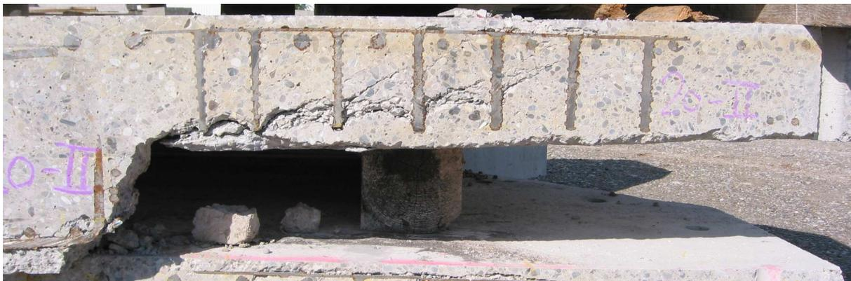
*Bild 6:* Schnittbild der Versuchsplatte 20-II
